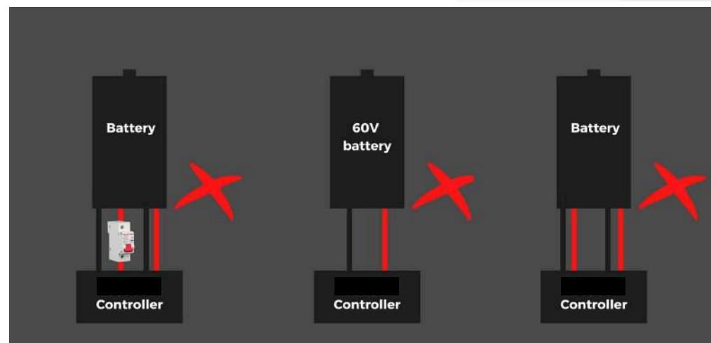
Le contrôleur TC1000 doit toujours être utilisé avec le disjoncteur (fusible) d'origine SurRon/Segway !
