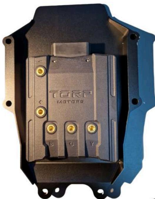
Utilisez les 6 boulons et la clé hexagonale (inclus dans le paquet) pour fixer le contrôleur au dissipateur thermique.
